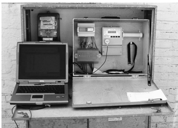
Figur 3. Mätutrustning för registrering av mätdata (tv) samt formeln (th) som användes till beräkna medelvärde av strömförbrukningen under 5 minuter. PC:n användes endast för att hämta in mätdata från anläggningen
